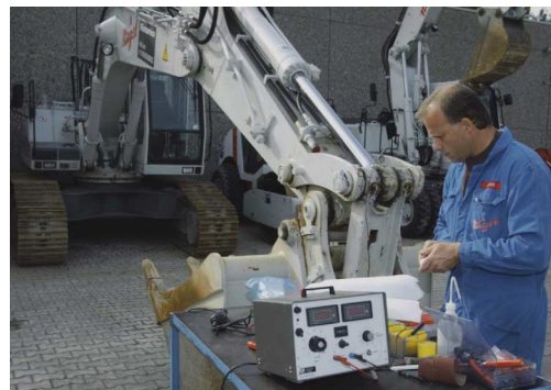
Abb. 2: Mit einem Set zum Tampongalvanisieren kann ein beschädigtes Teil vor Ort ohne Ausbau repariert werden
