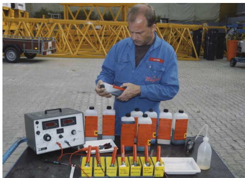
Abb. 3: Das Set enthält Netzgerät, Anoden mit Anodenhalter und verschiedene Elektrolyte
