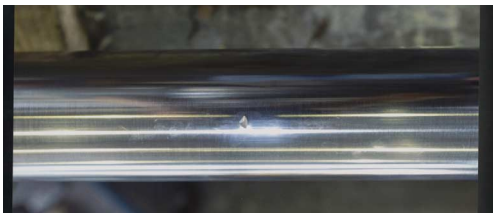
Abb. 1: Punktueller Schaden an der Kolbenstange eines Hydraulikzylinders, der in der Regel den Ausbau der Kolbenstange erforderlich macht
